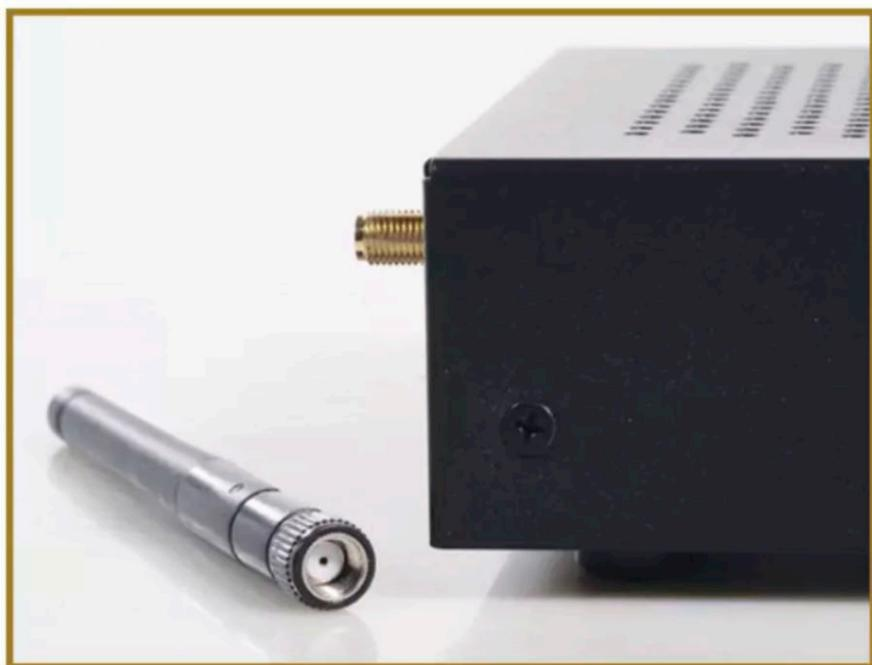
Zur reibungslosen Signalübertragung muss an der Rückseite des WTX-Tubes eine Empfangsantenne angeschraubt werden
