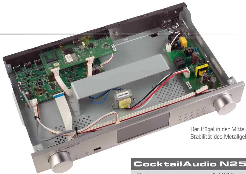
Der Bügel in der Mitte dient der Stabilität des Metallgehäuses
