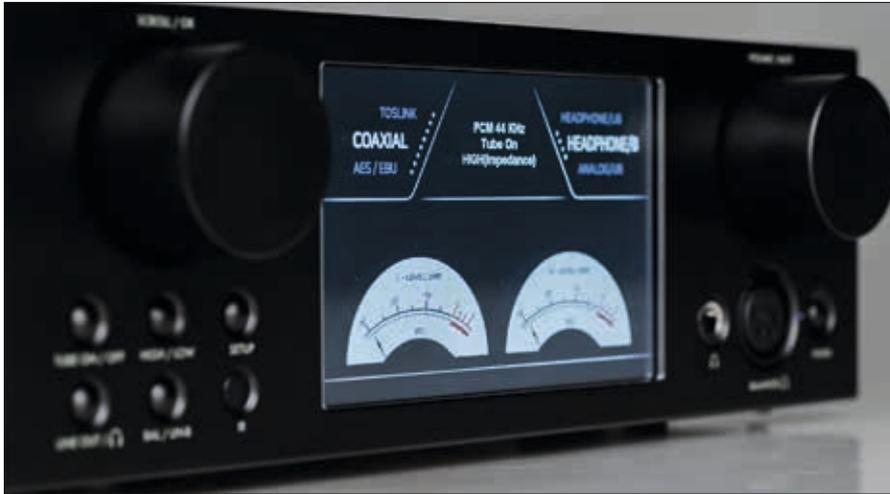
Über das 5 Zoll TFT LCD des HA500H lässt sich der Eingangspegel mittels schicker, digitaler VU-Meter-Imitationen anzeigen
