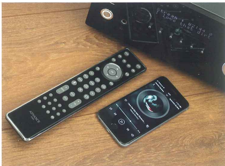
Der MyConnect 50 lässt sich wahlweise per Fernbedienung oder Smartphone-App steuern.
