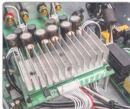
Mit seinen etwa 200 Watt Leistung ist der X35 sehr gut aufgestellt und arbeitet dank passiver Kühlung ganz ohne Lüfter
