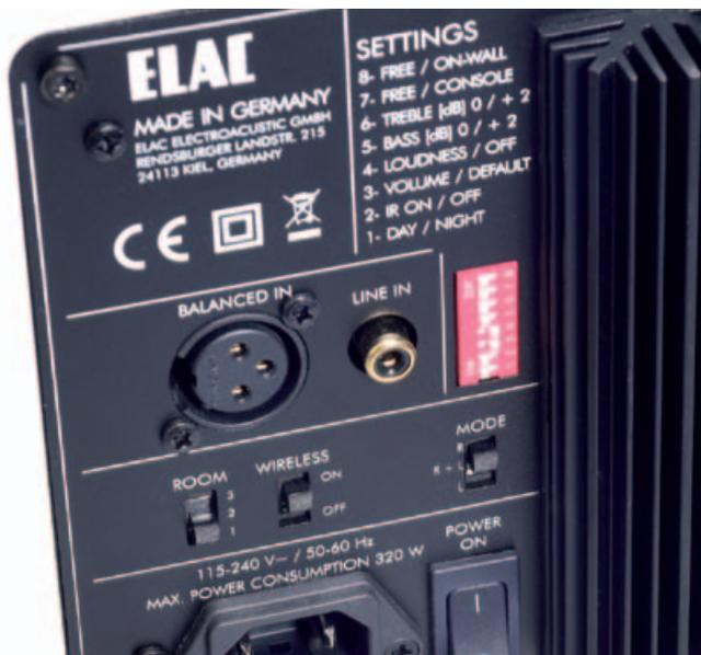
Das Terminal beinhaltet zwei analoge Eingänge und viele Schalter: Eine Ortsentzerrung für wandnah, die „Console“-Variante bei bündiger Aufstellung neben einem Sideboard, Höhen- und Bassanhebungen sowie Kanal- und Zonenwahl für die drahtlose Option.
