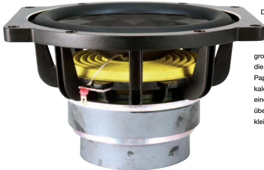
Der Tieftöner deutet mit seiner sehr großen Sicke und mehrfach gefalteten Zentrierung schon auf große Hübe hin. Trotzdem fällt die Sandwich-Membran aus Pappkonus und Alu-Kristallkalotte recht leicht aus. Für einen so starken Bass auch überraschend ist die recht kleine Schwingspule.
