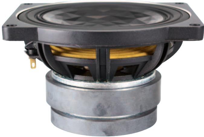
Die mehrteilige Sicke des Kristall-Mitteltöners ist maximal flach aufgebaut, um Beugungs- und Brechungseffekten keinerlei Chance zu geben. Trotz der eher geringen notwendigen Hübe sind Magnetantrieb und Zentrierung sehr großzügig konstruiert.
