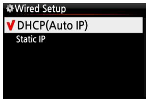
① Wählen Sie DHCP(Automatische IP) und bestätigen mit der OK-Taste. Es müssen keine Werte eingegeben werden.
