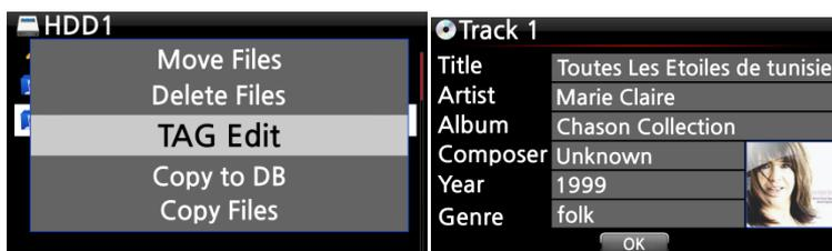
Wenn Sie die Daten einer Datei bearbeiten möchten, markieren Sie die entsprechende Datei mit dem Cursor und drücken Sie die MENÜ-Taste. Wählen Sie den Menüpunkt „TAG bearbeiten“ und bestätigen Sie mit der OK-Taste.
