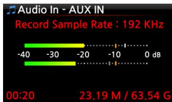
Während der Wiedergabe von Musik über einen der Eingänge des X40, drücken Sie einfach die REC-Taste auf der Fernbedienung und die Aufnahme beginnt (siehe Bild). Zum Beenden der Aufnahme drücken Sie die STOP-Taste.
