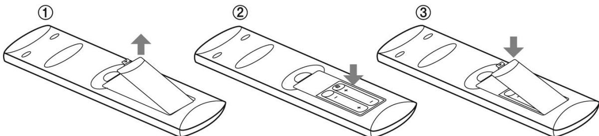
Öffnen Sie das Batteriefach und legen Sie die beiden AAA-Batterien ein.
