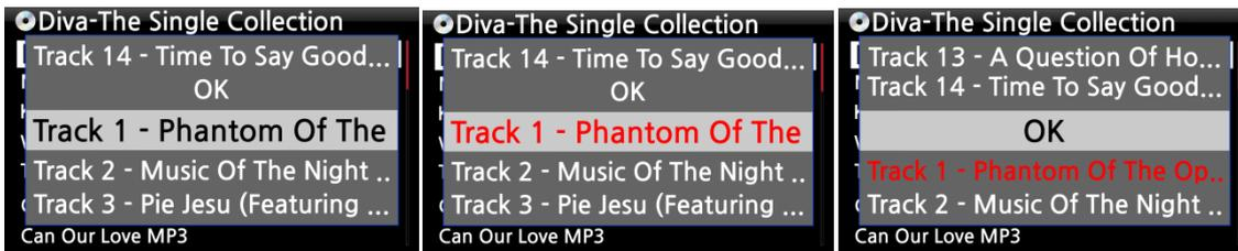
② Mit der RECHTEN PFEIL-Taste wählen Sie das/die Musikstück(e) aus, das/die Sie auslesen (rippen) möchten und bestätigen Sie mit der OK-Taste. Das bzw. die ausgewählten Titel werden dann rot angezeigt. Wenn Sie mit der Auswahl fertig sind, wählen Sie "OK" und bestätigen mit der OK-Taste.
