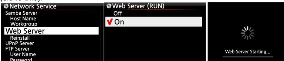
Wählen Sie Neuinstallation und bestätigen Sie mit der OK-Taste. Web Server wird neu installiert (siehe Bild).
