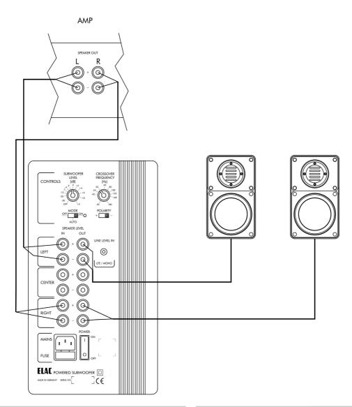
3 Lautsprecher-Kabel, Stereo, mit kleinen Satelliten (ohne eingebauten Hochpassfilter)
