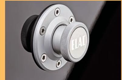
**Wer den rückwärtigen Knopf ganz hineindreht, der schiebt den Töner nach außen, wodurch sich seine Abstrahlkeule verbreitert (u.), was mehr Reflexionen im Raum erzeugt**
