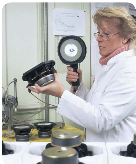
Jedes einzelne Chassis wird bei Elac sorgfältig geprüft und Belastungstests unterzogen
