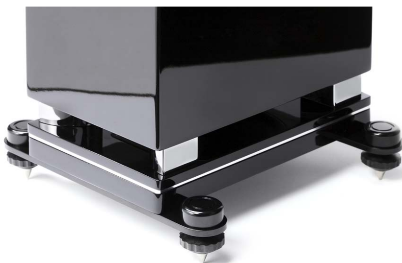
Am Korpusboden befindet sich die Austrittsöffnung des Bassreflex-Kanals, die Stege zwischen der Gehäuseunterseite und der Oberseite der Bodenplatte lockern daher nicht nur die Optik des FS 407 auf, sie sind wegen des Downfire-Prinzips notwendig
