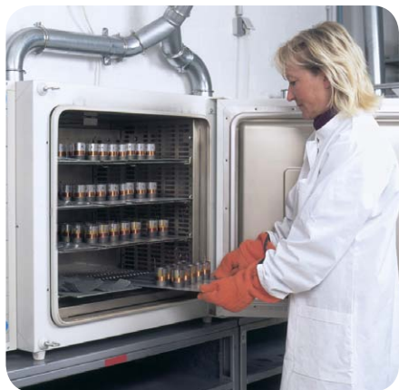
Elac fertigt Komponenten von Lautsprecherchassis selbst, hier zu sehen: Spulen im Backofen
