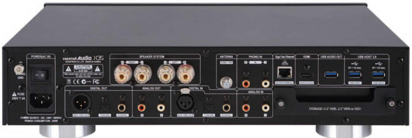
Die analogen und digitalen Eingänge entlarven den X35 als Recorder. Auch von allen anderen Quellen sind Aufnahmen möglich, und zwar mit Aussteuerung und manueller wie automatischer Schneidmöglichkeit. Weiterhin gibt es analoge und digitale Ausgänge für Endstufen sowie eine Buchse für einen USB-DAC. Über den HDMI-Ausgang lässt sich ein TV-Gerät anschließen, auch die Audioausgabe ist darüber möglich.
