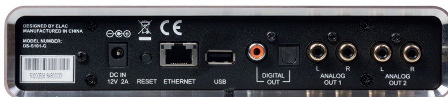
Alle Verbindungsmöglichkeiten befinden sich auf der Rückseite. Der Discovery besitzt vorbildlich digitale und analoge Ausgänge
