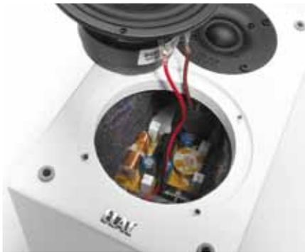
**VOLLE KONTROLLE:** Das üppig bestückte Netzwerk liegt an der Rückwand. Matten aus grauem Vlies sorgen für Dämmung.
