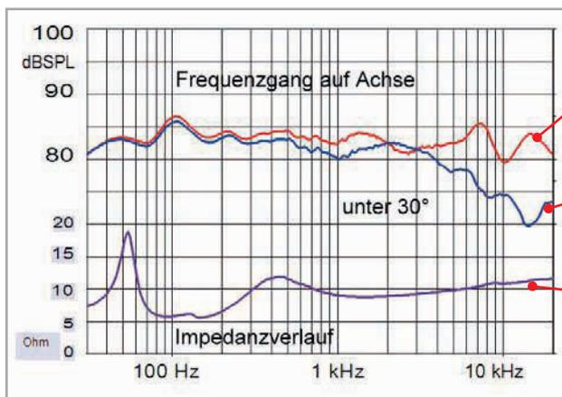
Der Beispiel-Frequenzgang ist auf Achse insgesamt zwar noch recht ausgeglichen, zeigt aber auch einzelne ausgeprägte Welligkeiten. Die Raumeinflüsse werden messtechnisch ausgeblendet.
