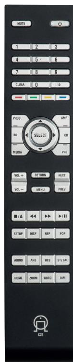
Die optisch klar gegliederte Infrarot-Fernbedienung steuert beide Primare-Komponenten und wird zwingend benötigt, um alle tiefer gehenden Funktionen der Bausteine zu bedienen
