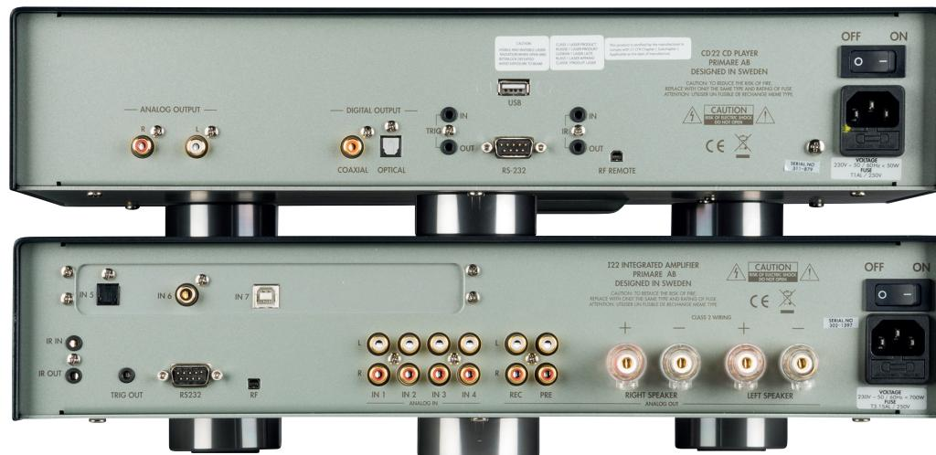
Ab Werk wurde ein DAC-Modul in den Primare Vollverstärker I22 integriert. So stehen zusätzlich drei Digitaleingänge zur Verfügung, die Signale bis 24-bit/192 kHz verarbeiten können
